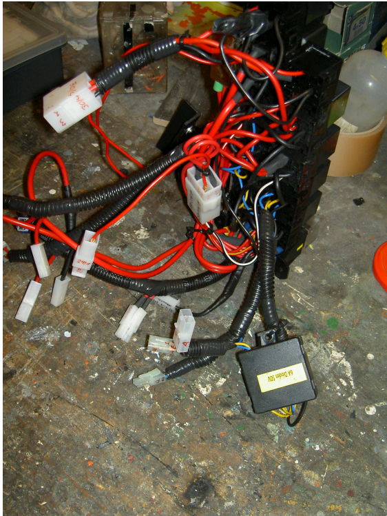
Rückenansicht Relai-Schaltung , mit Steckverbindungen der Zuleitungen.
